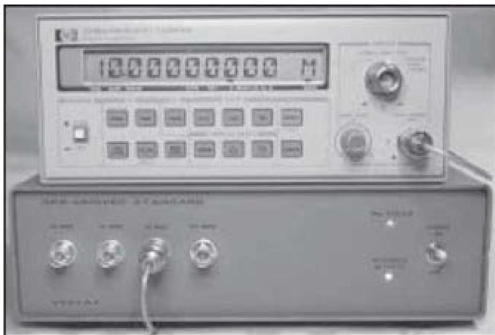
**Фотография В** — Эта фотография показывает подключение эталона частоты с управлением по GPS к частотомеру НР.
