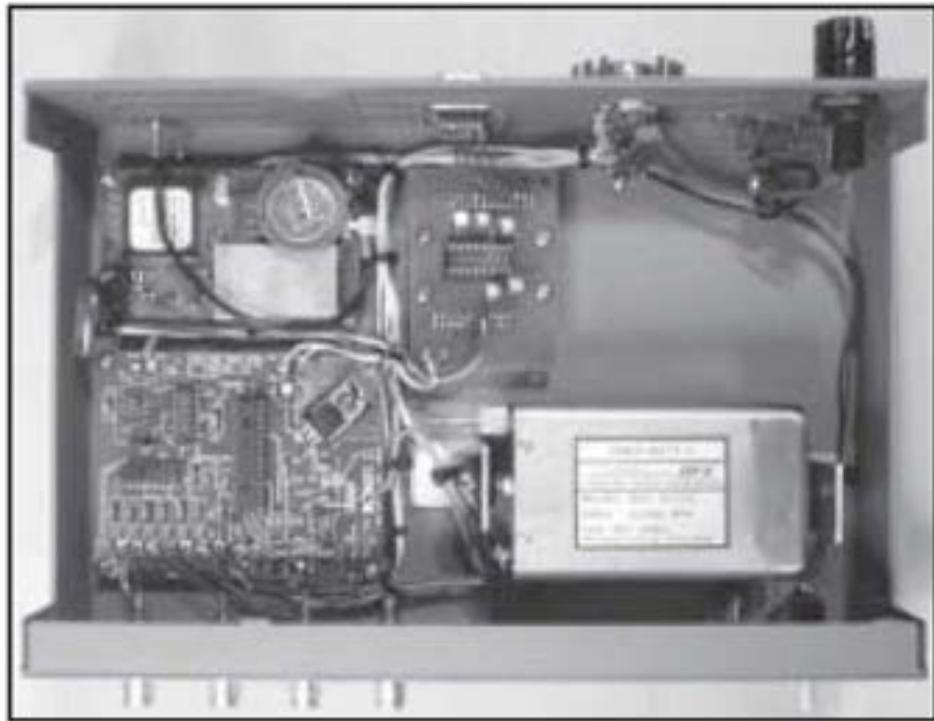
**Фотография А** — Собранная в корпусе система эталона частоты. Модуль в левом верхнем углу - плата GPS. Модуль слева внизу - плата контроллера FLL, а управляемый термостатированный кварцевый генератор находится справа внизу. Конвертер RS232 с обвязкой находится на плате наверху в центре. В верхнем правом углу регулятор на 8 В, и вход DC с держателем плавкого предохранителя.
